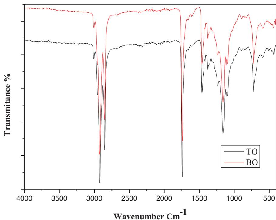
**Fig. 4.** FTIR spectra of TiziOuzou lentisk oil (TO) and Boumerdes lentisk oil (BO).
